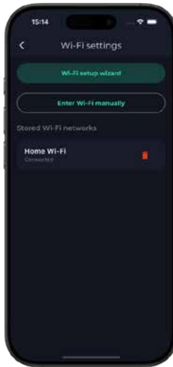
Můžete nakonfigurovat až deset různých Wi-Fi sítí. V mobilní aplikaci si můžete zobrazit přehled již přidaných Wi-Fi a případně odstranit nežádoucí. V nastavení Wi-Fi je možné také manuální přidání Wi-Fi (např. skryté) zadáním SSID routeru a hesla k Wi-Fi síti.
