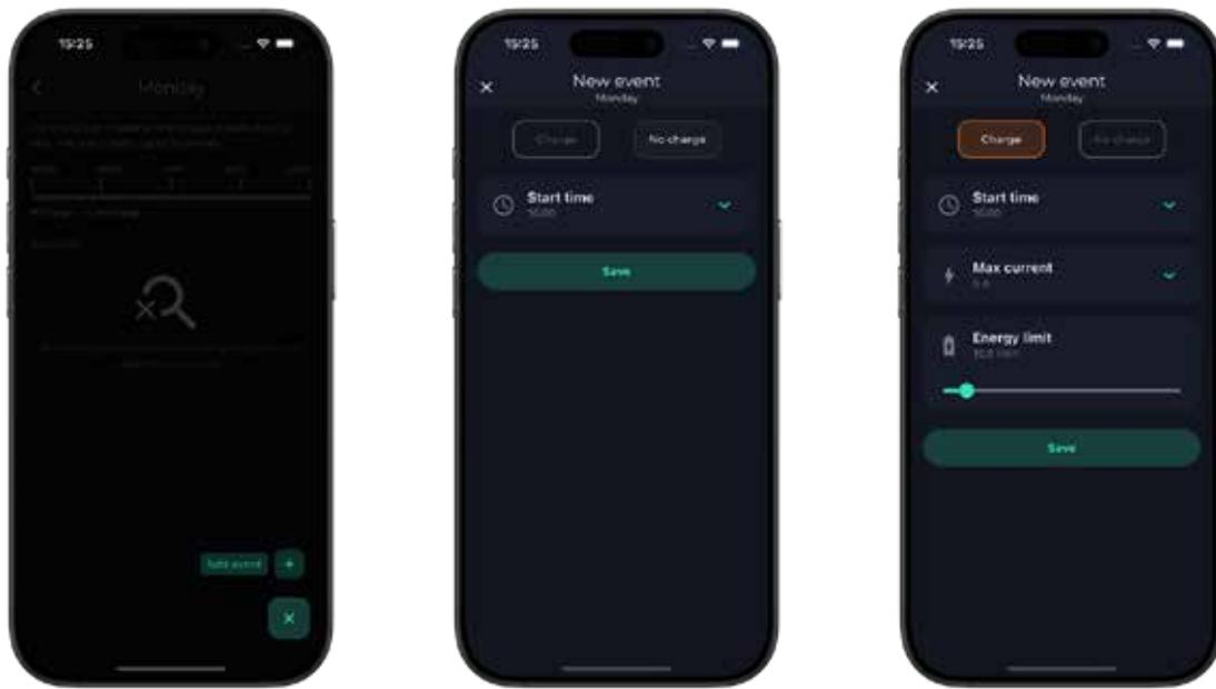
Klikněte na tlačítko "přidat událost". Vyberte si čas spuštění nabíjení, nabíjecí proud a limit kWh, které chcete nabít (pokud bude hodnota 0 kWh, nabíjení bude ukončeno až limitem nastaveném ve Vašem elektromobilu, nebo zvoleným časem ukončení nabíjení). Zvolte, zda v této události chcete nabíjení spustit či ukončit.
